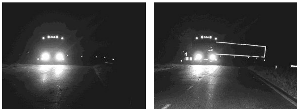
Figuur 8 Manoeuvrerende truck met oplegger (achteruit instekend in een oprit), zoals gezien doortegemoetkomend verkeer; met alleen zijmarkeringslichten (links) en met additionele contourmarkering (rechts) (Alferdinck e.a., 2002).
