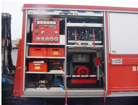
In brandweervoertuig ingebouwd generator-aggregaat
