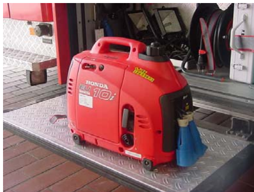
Klein generator-aggregaat met isolatiebewaking
